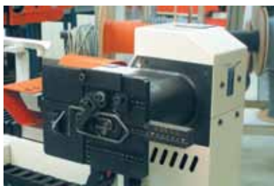
Для уменьшения длины прямого участка на конце изделия с обратной стороны станка установлена кондукторная рамка с функцией догибания изделия
