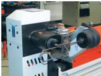
Гибка производится относительно гибочного носа методом обкатки с постоянным радиусом гибки
